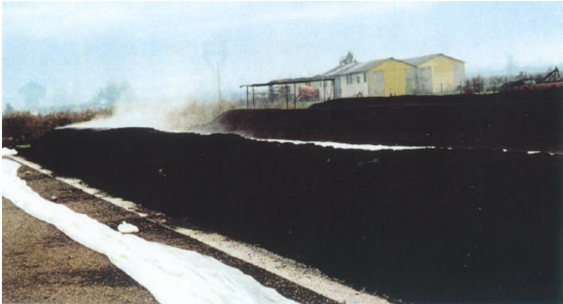
Vista general de pilas de compost en una planta de Kalamata (Grecia). La duración de la fase termofílica depende del tiempo durante el que se añade alpechín a la pila.
