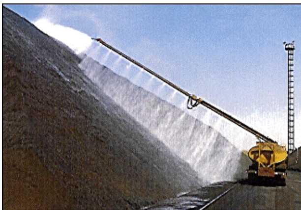
Figura 4.20: El rociado uniforme tiene una importancia capital para la formación de una costra adecuada [134, Corus, 1995]
