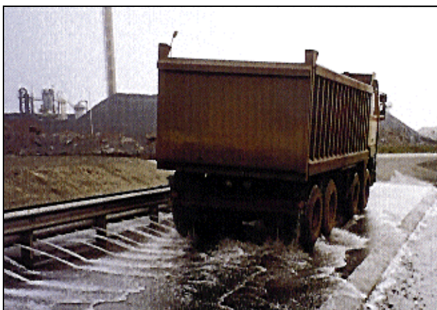
Figura 4.32: Piscina de agua en combinación con agua corriente para limpiar la superficie de rodadura de los neumáticos [134, Corus, 1995]
