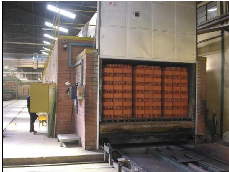
Imagen 3.9: Horno túnel, material saliendo después del proceso de cocción
