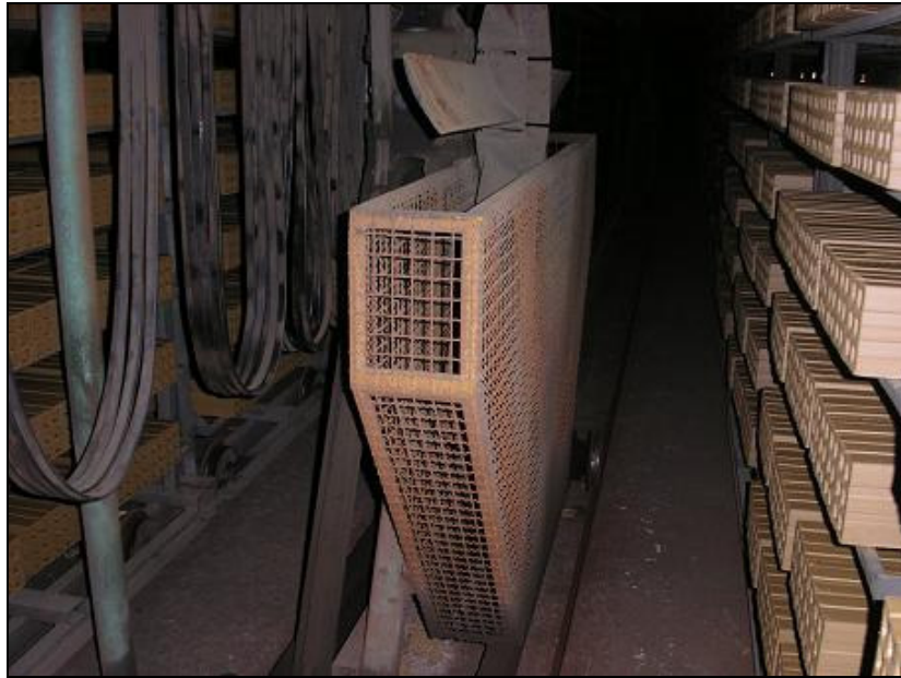
Imagen 3.8: Ventiladores para el movimiento del aire dentro del secadero
