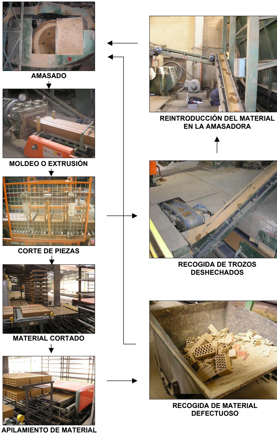
Figura 7.1: Esquema de reaprovechamiento de material defectuoso antes de la cocción
