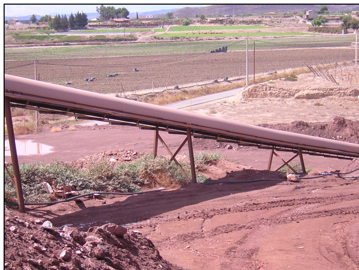
Imagen 6.4: Cinta tapada para el transporte de arcilla
