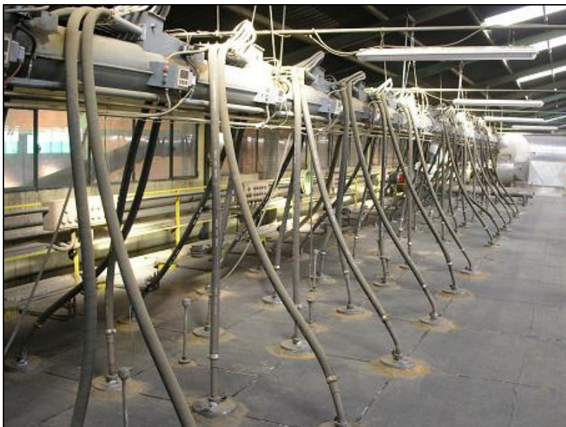
Imagen 2.2: Horno cerámico con quemadores de alimentación mixta de fuel y coque micronizado
