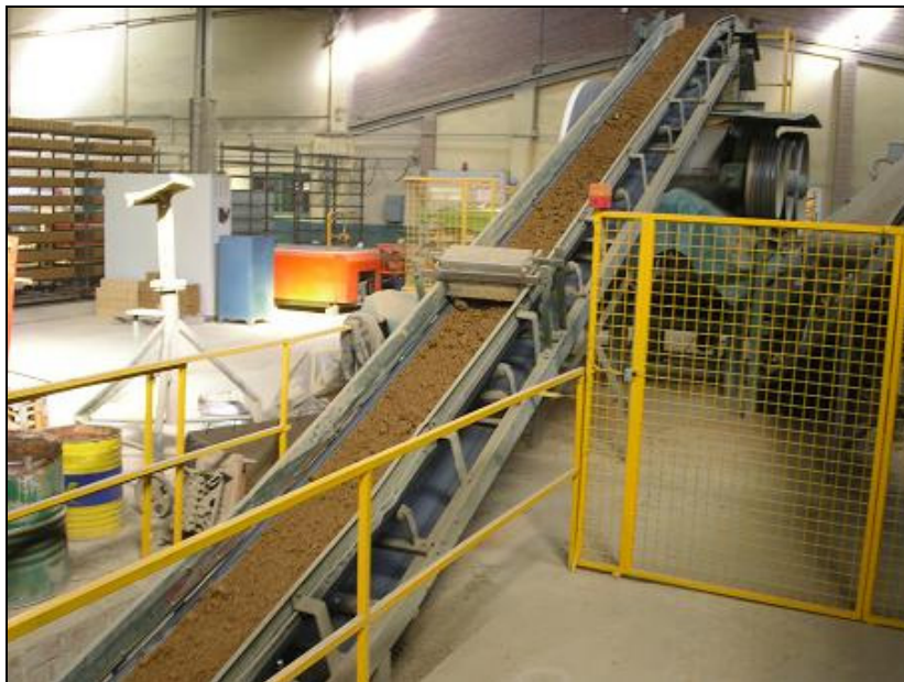
Imagen 3.2: Transporte de arcilla dentro de la instalación mediante cintas de goma
