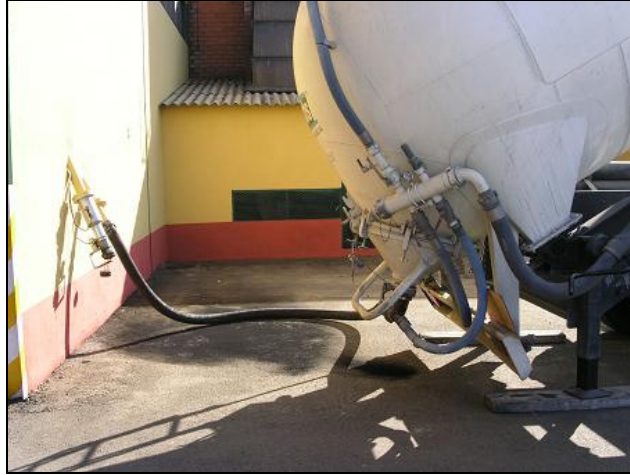
Imagen 7.1: Suministro de coque de petróleo a la instalación
