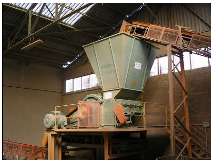
Imagen 3.4: Molienda por vía semi-húmeda
