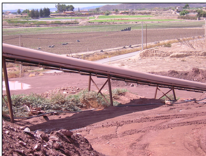
Photo donnée par Cerámica Carbonell Photo 6.4 : Convoyeur à bande capoté destiné au transport de l'argile
