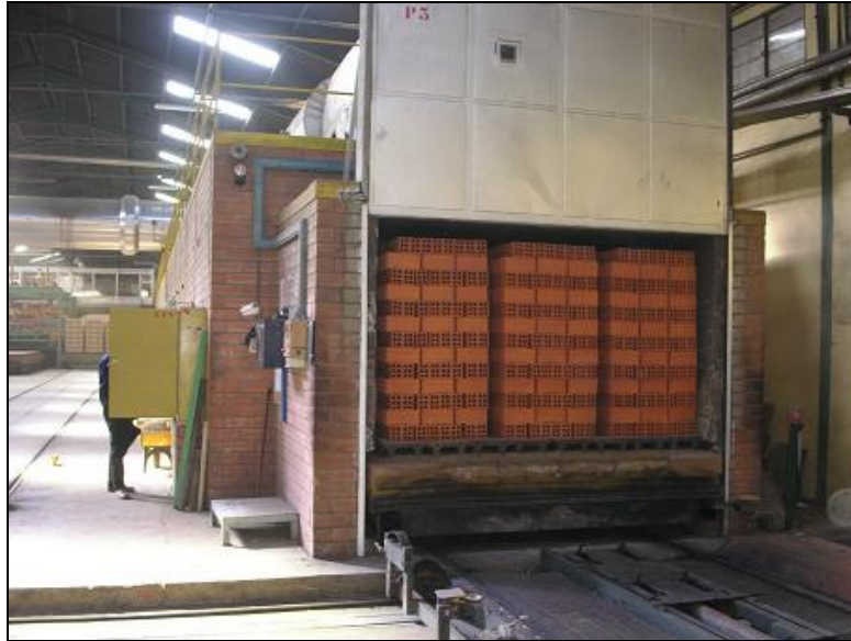
Photo 3.9 : Four tunnel, produit au sortir du processus de cuisson
