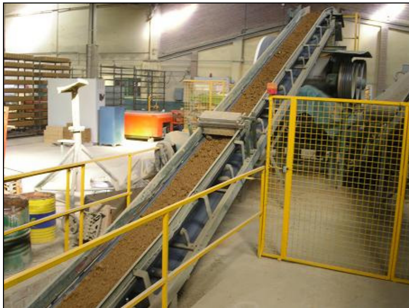
Photo 3.2 : Transport de l'argile au sein du site par le biais de convoyeurs à bande en caoutchouc
