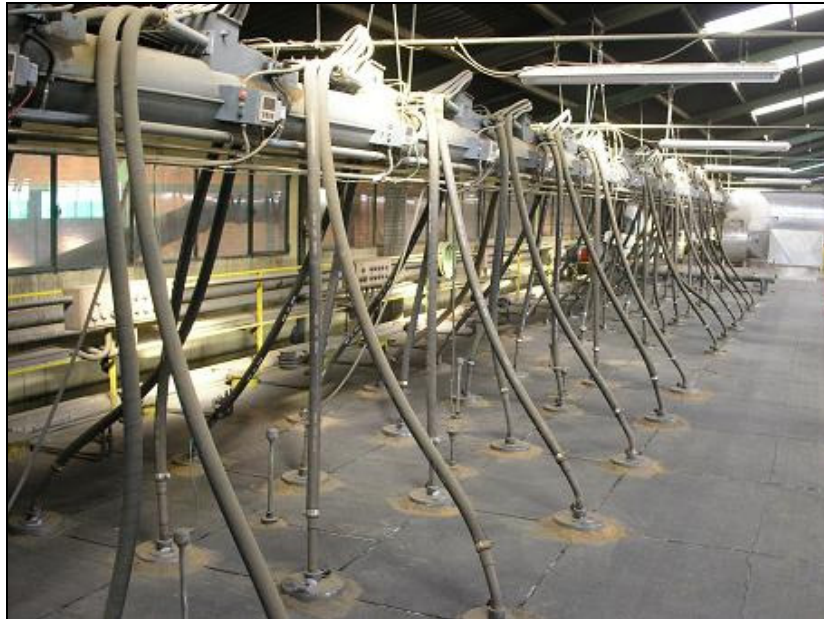
Photo 2.2 : Four à céramique équipé de brûleurs à alimentation mixte fioul/coke micronisé
