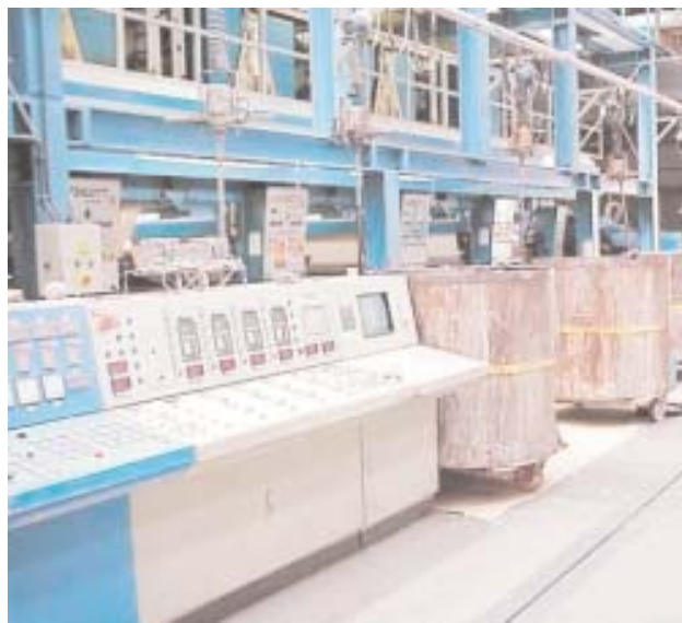
Au fond, la ligne de l'impression et devant, les encriers mobiles
