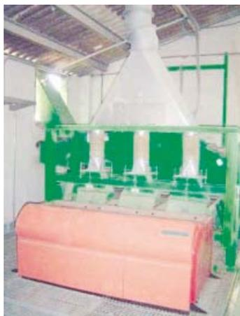
*Máquina para separar el vidrio contenido dentro del desecho del reciclaje de vidrio*
