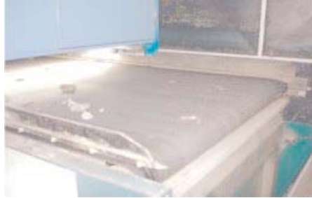
Máquina de visión artificial para separar los metales contenidos en los residuos comunes
