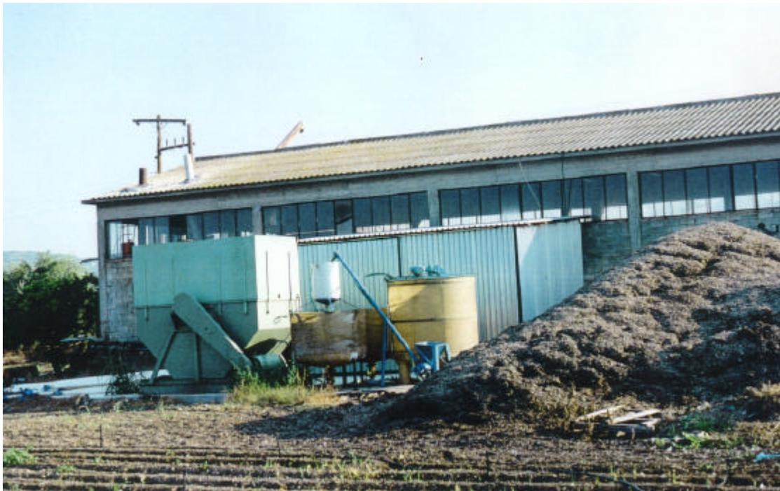
Installation pour la transformation des margines à engrais liquide
