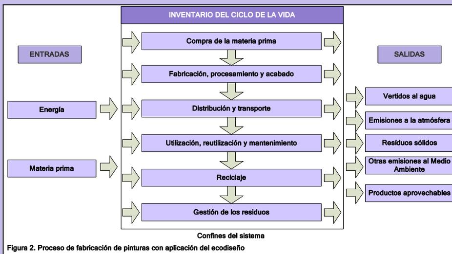
Figura 2. Proceso de fabricación de pinturas con aplicación del ecodiseño
