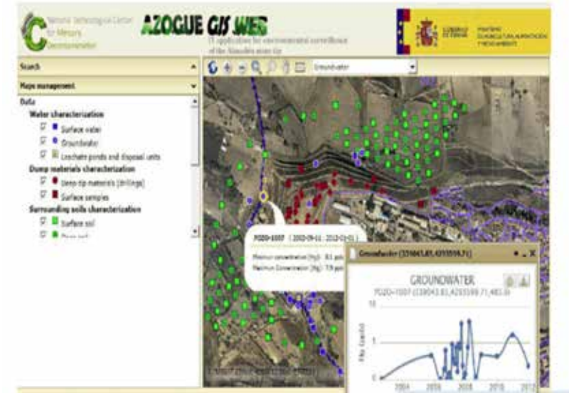
Application logicielle pour la surveillance de l'environnement de la mine d'Almadén http://www.ctndm.es/proyectos/1-in.php
